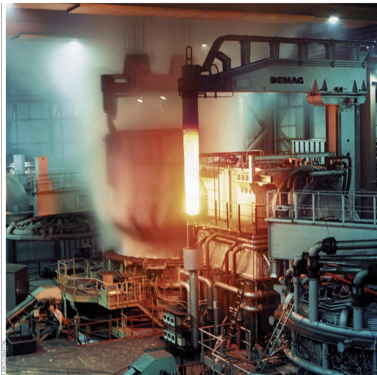
2 L'électrode incandescente d'un four à arc électrique
